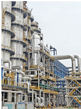
中山大学与企业联合开发的余热回收耦合热泵变压精馏技术，年节约蒸汽超36万吨
